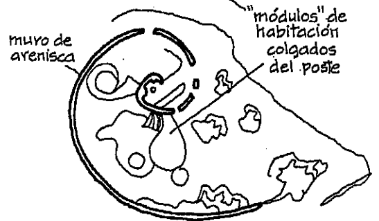
planta y sección de la Bavinger House de Bruce Goff (1957) en un emplazamiento muy remoto de Oklahoma
