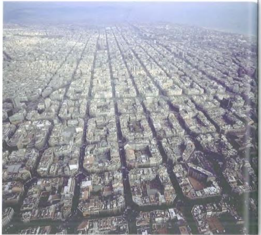
Fotografía aérea del Plan de Ensanche de Barcelona, ideado por Ildefons Cerdà , en el que se puede apreciar claramente la distribución reticular de las calles.
